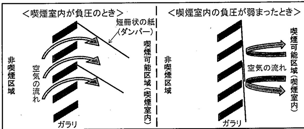
※ 喫煙室内の負圧が弱まると、ガラリー等の開口面から喫煙室内の空気（たばこ煙）が漏れ出すおそれがあるが、ダンパーがあると開口面を塞ぐため、たばこ煙の非喫煙区域への漏えいを低減することができる。
